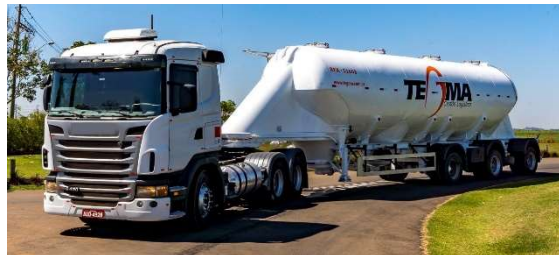
Foto 1: Carreta-silo da operação de químicos
